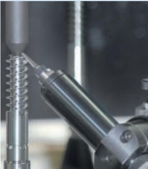
**Präzises Entgraten mit Fingerfräser und Schleifbürste, hier an Schneckenwellen für eine elektronische Servolenkung**
