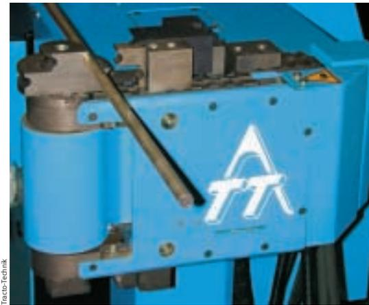
Die Biegemaschine Tubotron 20 von Tracto-Technik: vor dem Biegen und ...
