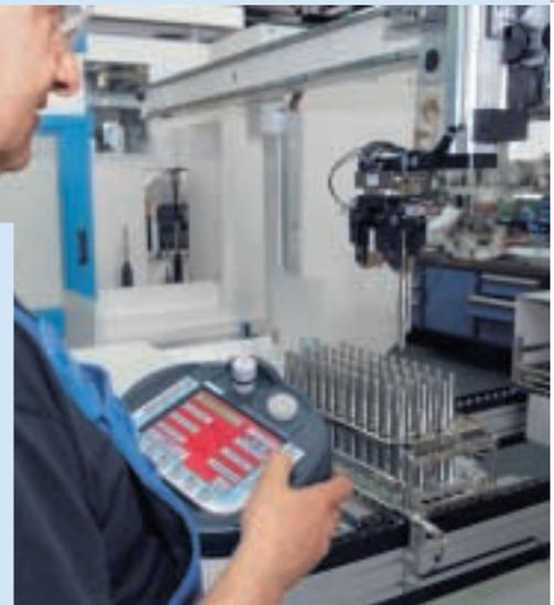
**Das Simatic Mobile Panel 170 macht das Einrichten der Maschine vor Ort komfortabler denn je – im Bild der Portal-lader mit Werkstücken zur Entgratung**
