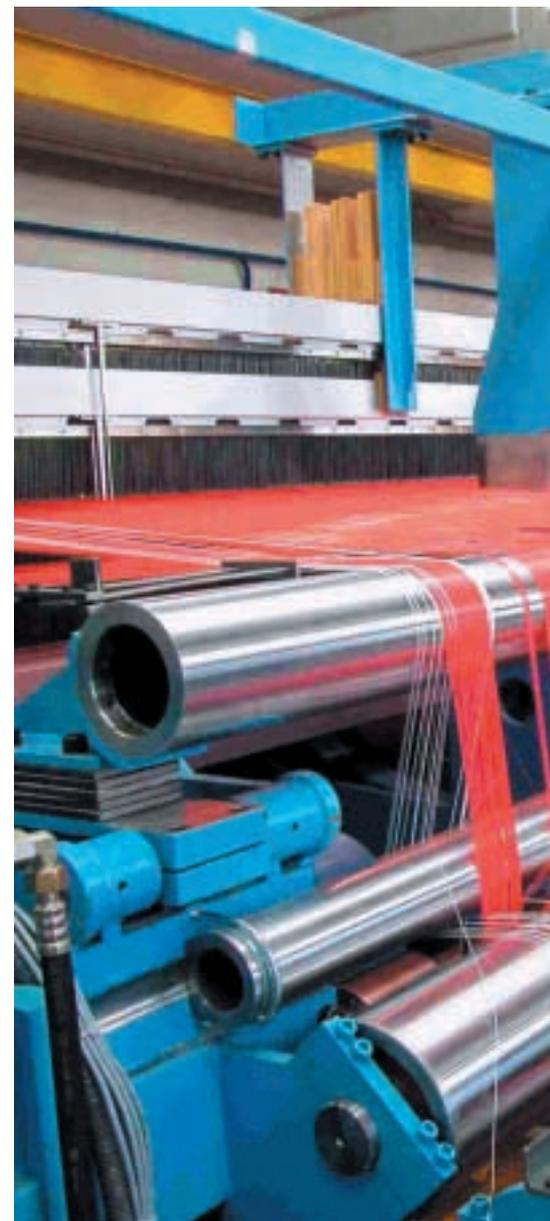
angelegter Achsinstanzen werden die benötigten Achsen nur noch aktiviert. Damit ist die neue Kettbaumachse auch sofort in den geschlossenen Regelkreis eingebunden, der die Kettfadenspannung über Messwalzen kontrolliert.
